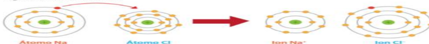
Figura 1: Enlace iónico del NaCl
