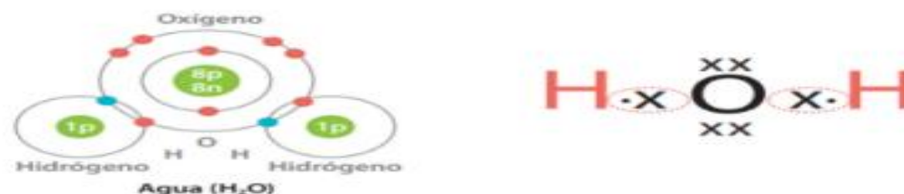
Figura 2: Diagrama de Bóhr y estructura del enlace en la molécula de agua.
