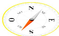
Es un instrumento de orientación que utiliza una aguja imantada para señalar el norte magnético terrestre. Nos permite saber dónde está el NORTE, SUR, ESTE, Y OESTE.
